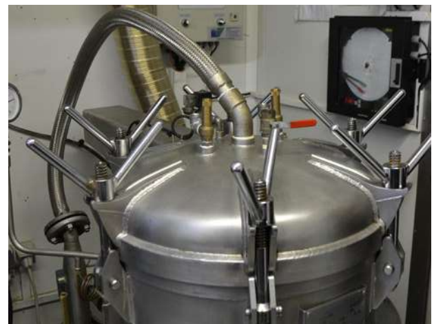
Autoclave avec pompe de recyclage, système de régulation et enregistrement à disque
